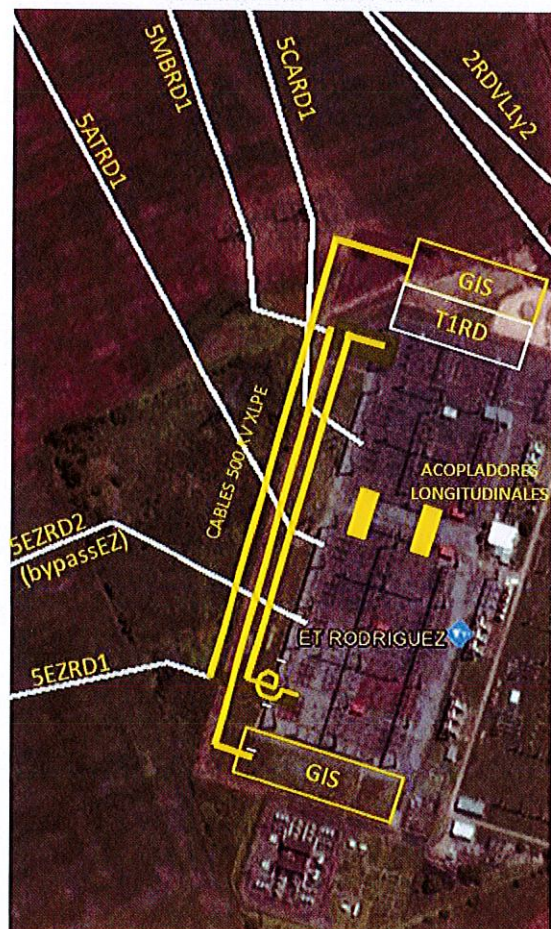
Figura 4 Esquema Geográfico de adecuaciones necesarias para separación de RD con CLR
